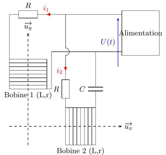
Déterminer expérimentalement les valeurs de  $C, r$  et  $L$ , puis en déduire les valeurs de  $\omega$  et  $R$  les plus adaptées.
