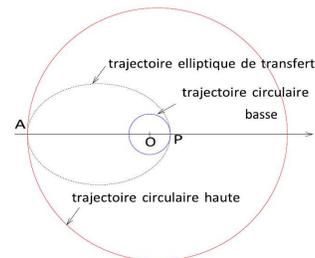
FIGURE 1 – Trajectoires prises par un satellite mis en orbite géostationnaire.
