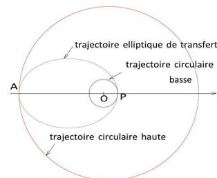
FIGURE 3 – Trajectoires prises par un satellite mis en orbite.
