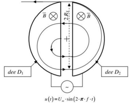
FIGURE 7 – Schéma de principe du cyclotron.
