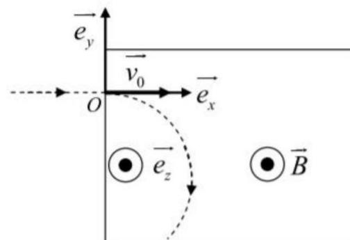
FIGURE 5 – Trajectoire d'une particule de charge  $q$  positive dans une région de l'espace où règne un champ magnétique uniforme.
