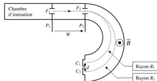
FIGURE 6 – Schéma de principe du spectrographe de masse.
