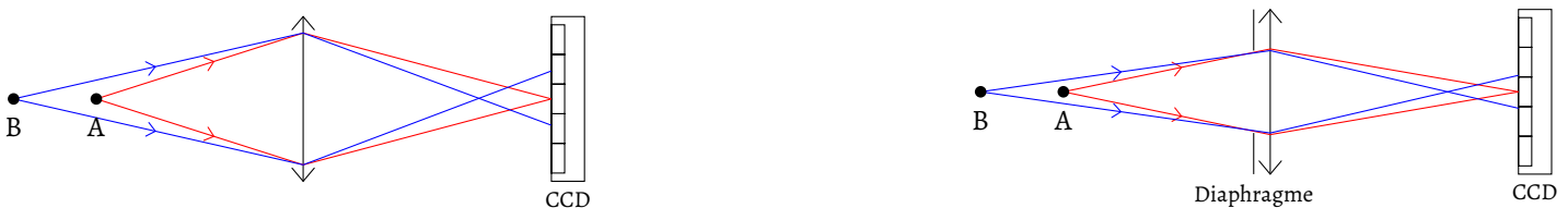
FIG. 3.3: Représentation d'un appareil photographique et de l'influence du diaphragme sur la profondeur de champs. A gauche, l'image de l'objet A par la lentille est situé sur la surface du capteur tandis que l'image de B est située avant le capteur : l'image de B forme une tache sur le capteur plus gros qu'un pixel du CCD. L'image de B sera donc floue alors que celle de A sera nette. A droite, on rajoute un diaphragme : les images de A et B sont identiques mais la tache formée par B est moins grande que la taille d'un pixel. Pour le CCD, un seul pixel sera éclairé : les images de A et de B seront nettes.
