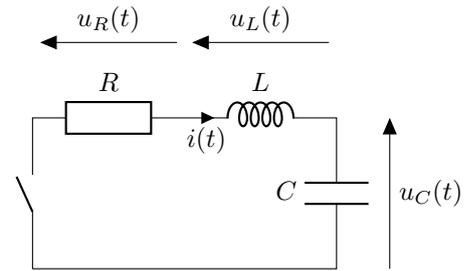
FIG. 15.3 – Schéma d'un circuit RLC série. Le circuit est préalablement chargé en  $t < 0$  et en  $t = 0$  on ferme l'interrupteur.
