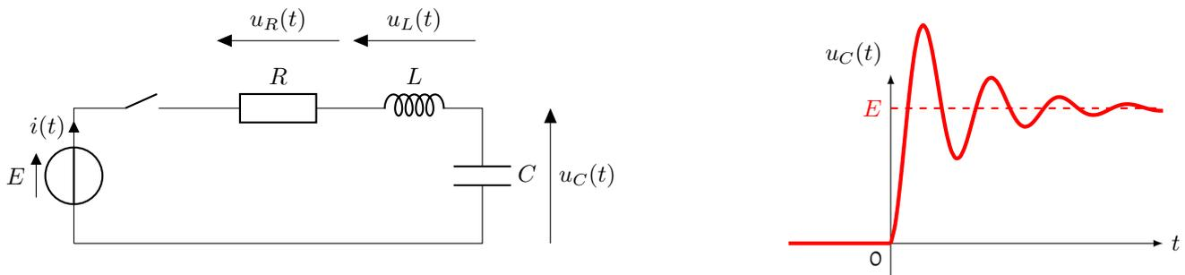
FIG. 15.1 – Représentation du circuit  $RLC$  série et visualisation de la tension aux bornes du condensateur après fermeture du circuit via l'interrupteur (en  $t = 0$ ).
