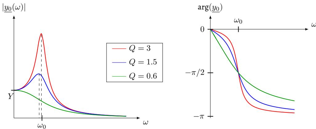
FIG. 15.4 – Représentation de l'amplitude et de la phase du système en fonction de la pulsation d'excitation pour différentes valeurs du facteur de qualité (d'après l'expression en (5.2)). On remarque que pour  $Q=0,6$  il n'existe pas de résonance pour une pulsation proche de  $\omega_0$  alors que la condition du régime pseudo-périodique est satisfaite ( $Q>1/2$ ).
