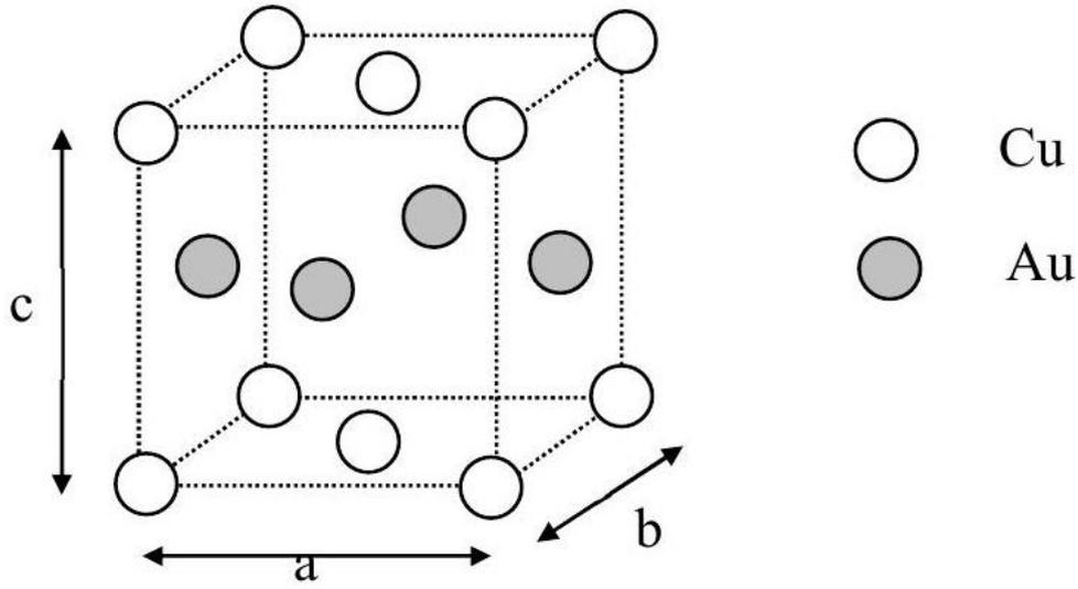
La tangence des atomes se fait **suivant les diagonales des faces du parallélépipède**. Les trois angles sont égaux à  $\pi/2$  et  $a = b \neq c$ .
