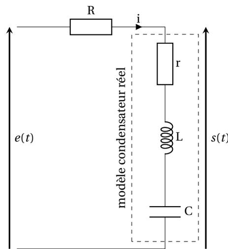
FIGURE 3 – Filtre RC où la capacité réelle est modélisée par un circuit RLC série.
