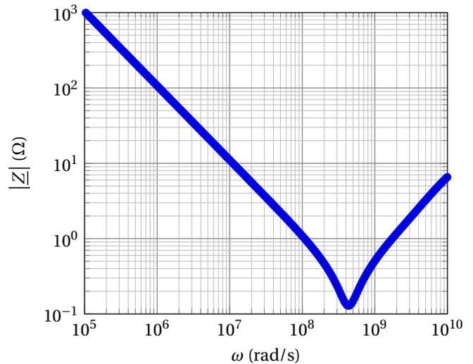
FIGURE 2 – Capacité de type céramique soudée à la surface d'une carte électronique à gauche et module de l'impédance d'une capacité réelle de type céramique à droite (condensateur C0402C103K7PAC de KEMET©).
