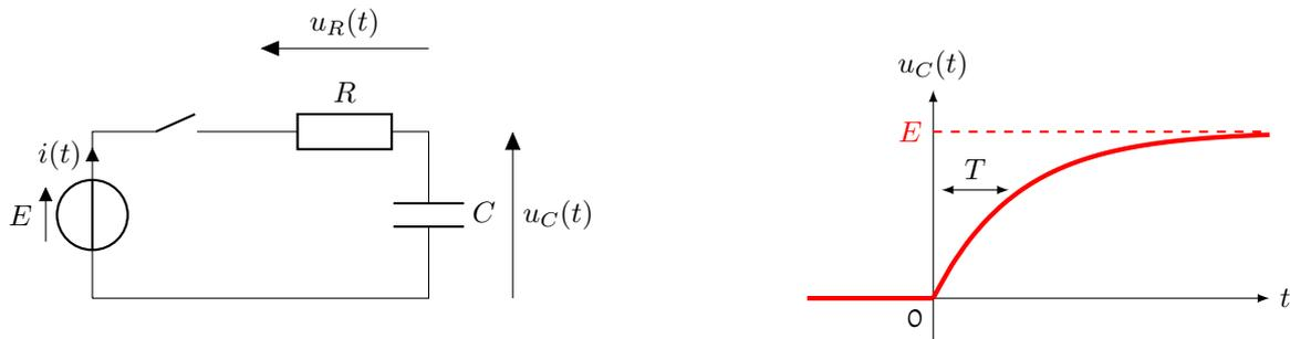
FIG. 14.2 – Représentation du circuit  $RC$  utilisé et visualisation de la réponse en tension au bornes du condensateur après fermeture du circuit via l'interrupteur (en  $t = 0$ ).
