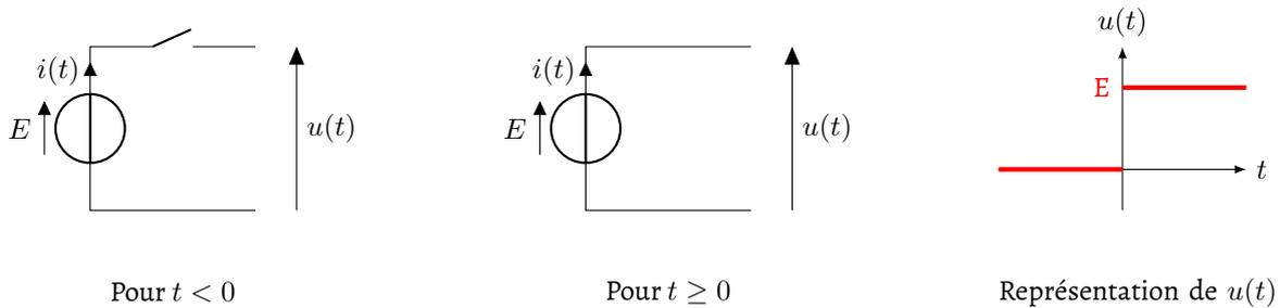
FIG. 14.1 – Représentation idéalisée d'un échelon de tension.
