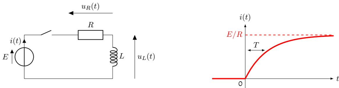
FIG. 14.3 – Représentation du circuit  $RL$  utilisé et visualisation de la réponse en courant traversant la bobine après fermeture du circuit via l'interrupteur (en  $t = 0$ ).
